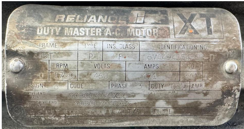
Imagen 1. Datos de placa del motor
